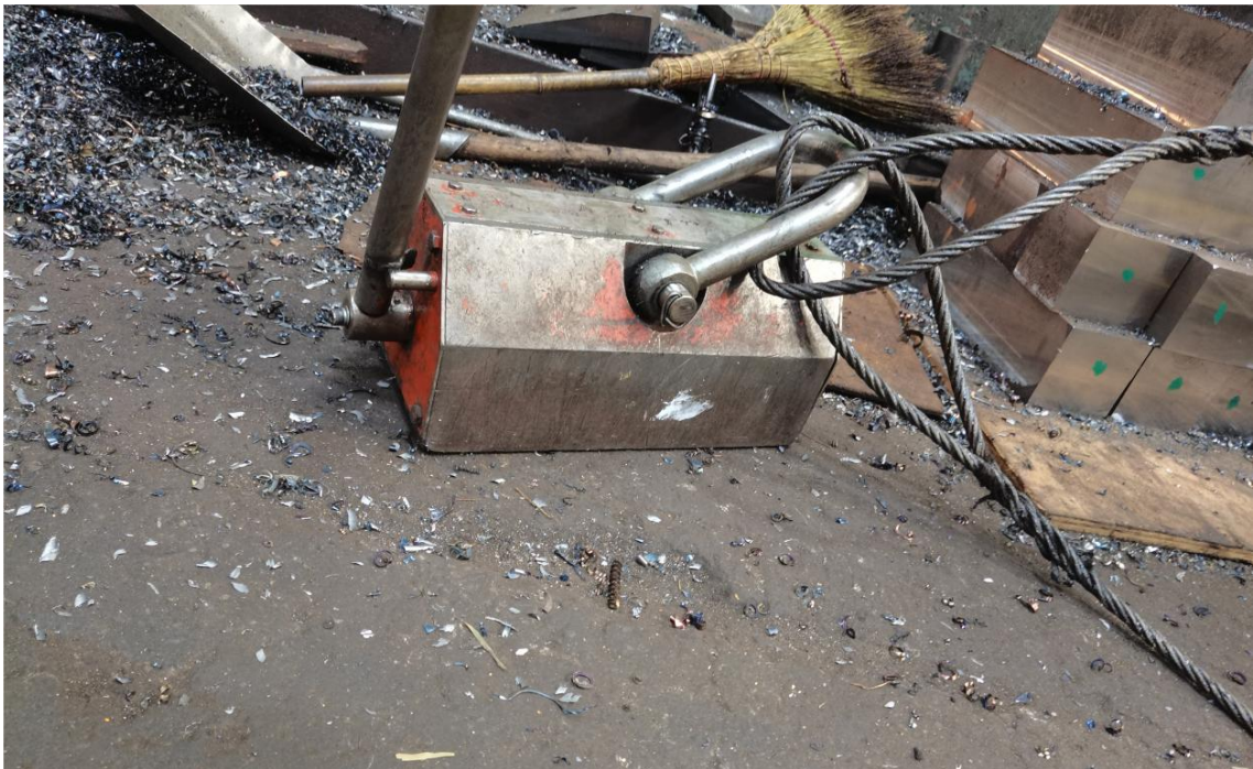
图 3 图为事故使用的起重永磁铁
